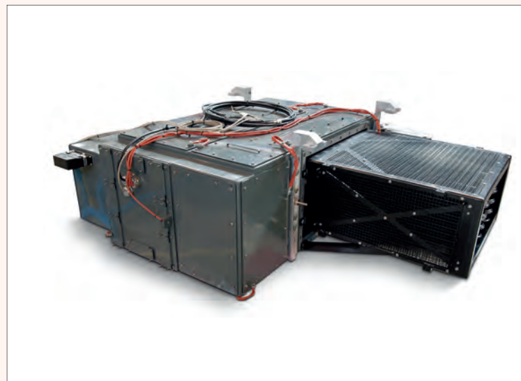
Systeem voor warmteafvoer voor een trein. © Calyos SA - M. Bries, Mandragore
