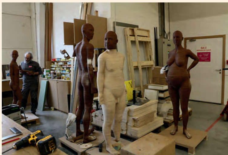
In het atelier: houten 3D - geprinte modellen op ware grootte, nog donkergebrand door de laser. © KBIN
